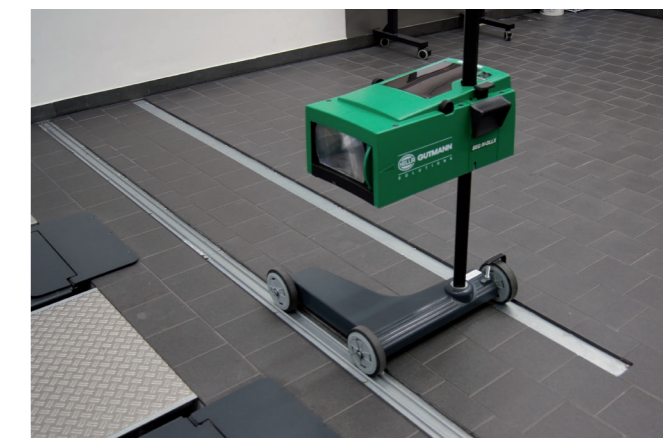
BILD 4: SEP mit versenkter Schienenkonstruktion (Quelle: Hella-Gutmann-Solutions)
